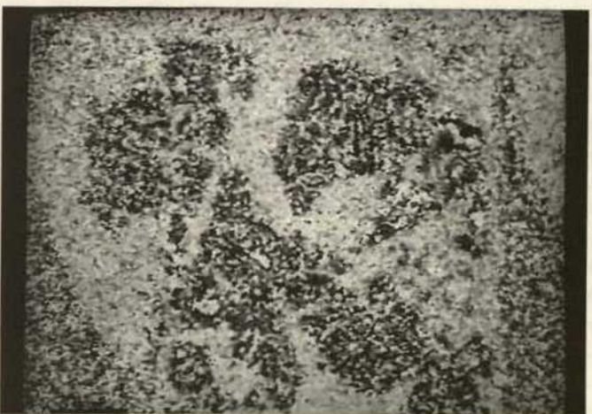
图 10. 视频全息摄影的含有衍射带的差值图。在约 60 % rh 时，湿度改变约 0.2 % rh 后产生的变形。在以前附着良好的区域的进一步损坏
