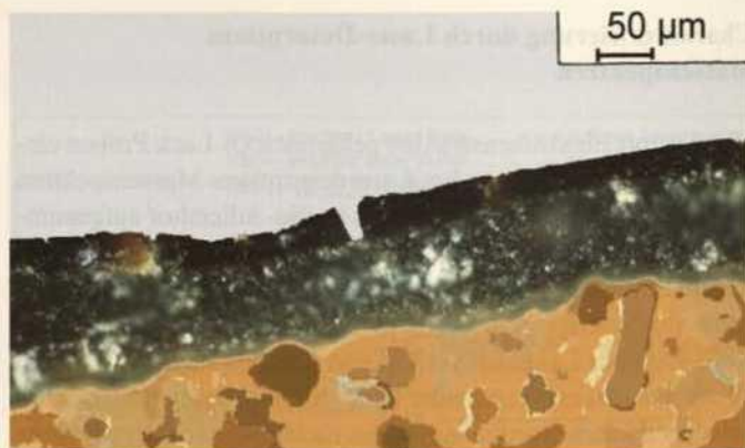
Abb. 3. Querschliff von Qi-Lack gefestigt mit Plex
