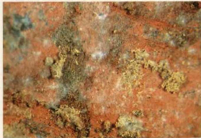
4. Fragment 011–1998 nach Entfernung der Erde bei 99 % rF vor der Konservierung der Farbfassung; Schimmelbefall auf einer Zinnober-schicht
