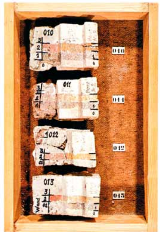
Abb. 4: Befundkästchen mit entnommenen Primärdokumenten von der Ostfassade des Wohnhauses Wahlenstraße 2 in Regensburg, August 1975. An den entnommenen Befundstücken mit den Stratigraphien sind alle wichtigen Fassadenelemente erfasst: Gesimse, Pilaster, Stuckrahmen um die Fenster. Die Entnahmestellen der Primärdokumente sind in der Dokumentation verzeichnet, die Stratigraphien in den Befundblättern erläutert. Archiviert im Bayerischen Landesamt für Denkmalpflege in München (Foto: Bayerisches Landesamt für Denkmalpflege)
