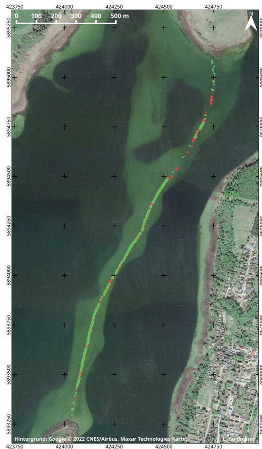
Abb. 6: Kartierung des Verlaufs der Langen Brücke basierend auf Sonarvermessung durch den VUBB.
