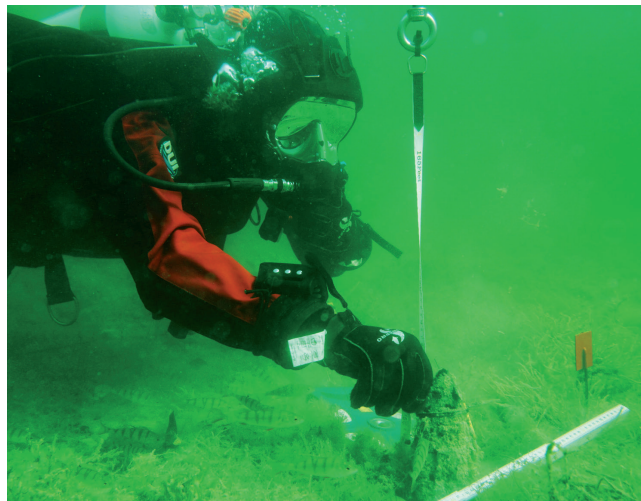
Abb. 9: Einsatz der DGPS-Boje, die vom Taucher per Stab geführt wird. Die Kommunikation mit dem Bediener des Messgerätes erfolgt per Unterwassersprechfunk.
