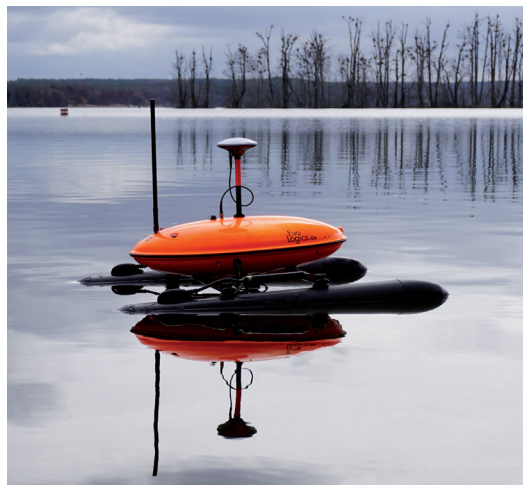
Abb. 5: „Unmanned surface vehicle“ (USV) Sonobot® beim Messeinsatz.
