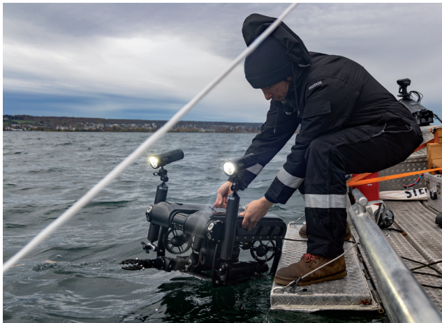
Abb. 2. ROV mit Greifarm im Einsatz der vom LAD beauftragten Firma Submaris (Abb. 2–9 LAD im RPS/Submaris).
