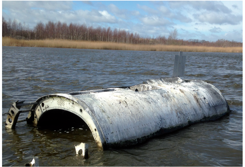
Abb. 1. Rumpfsegment mit zentralem Notausstieg und rund-ovalem Querschnitt (sofern nicht abweichend angegeben Fotos und Grafik K. Schaake).
