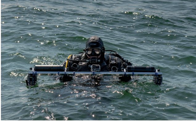
Abb. 2: Erster Test eines GoPro 11 Kameragestells zur fotogrammetrischen Erfassung an einem Wrack mit Kalkfässern in der Prorer Wieck vor Mukran. Archaeomare e.V. (Foto R. Obst, 2023).
