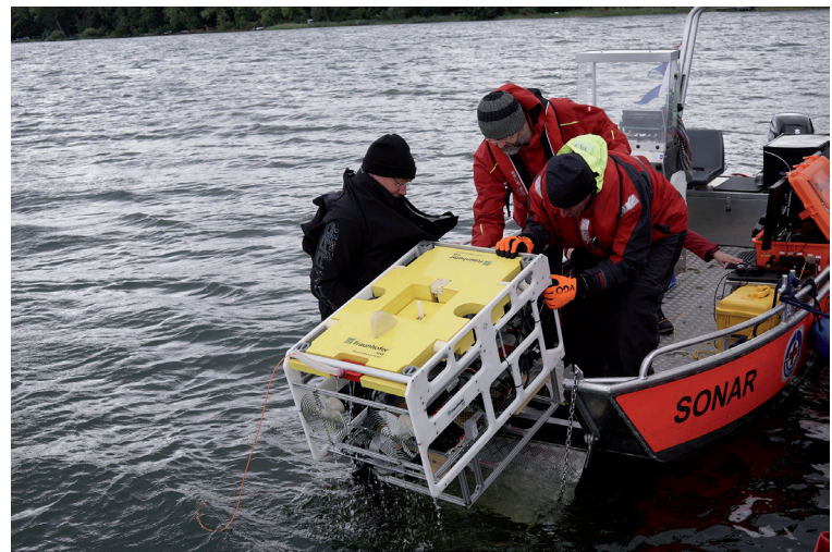
Abb. 3: Einsatz eines „Remotely Operated Vehicle“ (ROV) für die Unterwasserarchäologie am Arendsee, LDA/IOSB-AST 2024 (Foto Helge Renkewitz).
