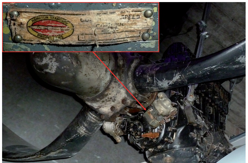
Abb. 2. Constant Speed Control von Hamilton Standard identifiziert den Motor als Packard Merlin V-1650.
