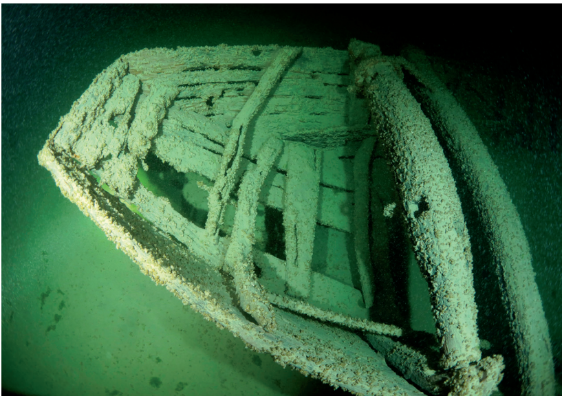
Abb. 11. Heck des Wracks W224. Zu erkennen ist der spindelförmige Triller. Eine Bodenplanke fehlt (Grafik H. Utz).
