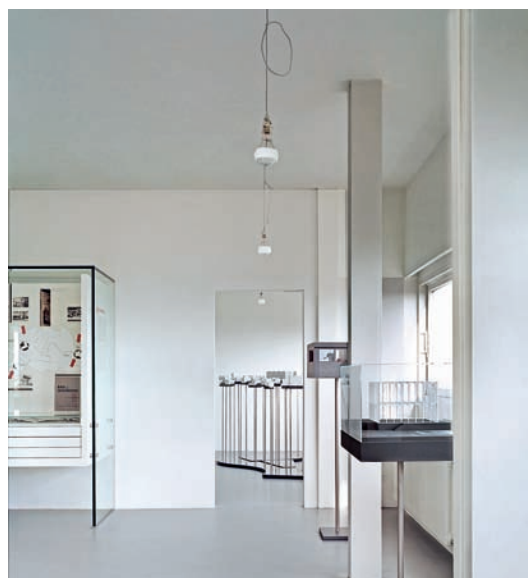
7 Einfacher kann ein Lichtkonzept kaum sein: In den Haupträumen hängen allseitig leuchtende Glühlampen von der Decke – wie ursprünglich bei Le Corbusier, nur in ihrer Materialität reduzierter als die Originale.
