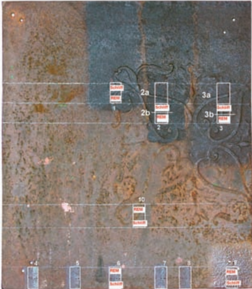
9 Mit verschiedenen Strahl- bzw. Reinigungsverfahren partiell behandelte renaissancezeitliche Ofenplatte aus Guss-eisen mit Markierung der vorgesehenen Untersuchungs-bereiche.
