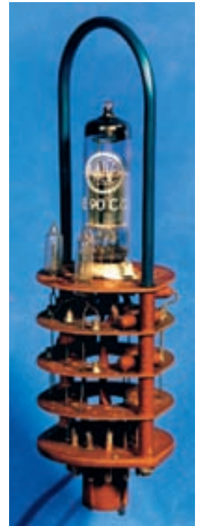
6 Röhrenbaustein der Rechenmaschine.
