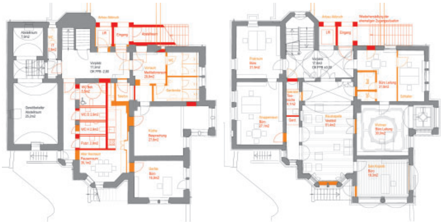
6 Grundriss Sockelgeschoss nach der Sanierung. Rot: Neubau, Gelb: Abbruch, Grau: Bestand.
