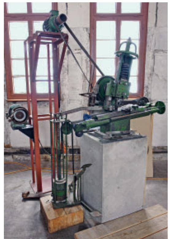
Der Feilenhauer stellte nicht nur neue Feilen her, sondern arbeitete auch gebrauchte beziehungsweise abgenutzte Feilen wieder auf. Dazu wurde die stumpf gewordene Feile zunächst weich gegläht, der alte Hieb abgeschliffen und die Feile in den alten Körper neu eingehauen und abschließend wieder gehärtet.
