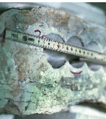
11 Unterseite des Hundes „Terzka“, nach der Entnahme von Bohrkernen. Foto: FMFA, Stuttgart.
