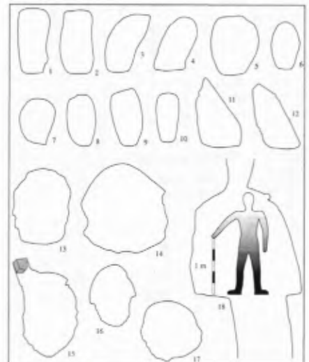
■ 9 Mittelalterliches Bergbaurevier St. Ulrich-Birkenberg: Stollenprofile in Grube 1 (1 bis 12, überwiegend Schlägel & Eisen-Arbeit); Stollenprofile in Grube 2 (13 bis 17, Feuersetz- sowie Schlägel & Eisen-Arbeit); von der Stollenfirste ausgehender, heute verschlossener Belüftungsschacht in Grube 2 (15); ehemalige Haspelstube über 15 Meter tiefem Förderschacht in Grube 2 (18).
