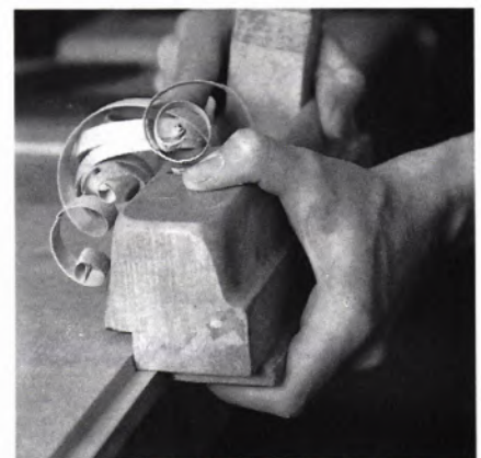
■ 5 An der Grundfläche des Spielbrettes wird mit dem Falzhobel ein umlaufender Falz hergestellt.
