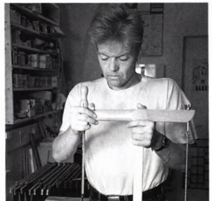
■ 4 Mit der Gestellsäge werden durch „Fausten“ die einzelnen Teile zugeschnitten.
