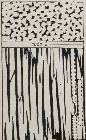
Abb. 5 Schema des interzellulären Hohlraumsystems (nach Frey-Wyssling) oben Querschnitt, unten Längsschnitt durch einen Teil der Zellwandstruktur.
