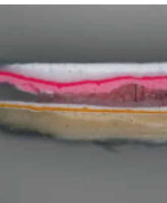
4 Mikroschliff mit Schichtenabfolge der verschiedenen Fassungen, Wand im Badezimmer 1. OG.
