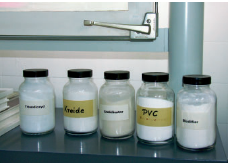
7 Materialzusammensetzung der PVC-Profile.
