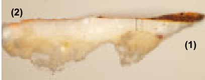
Abb. 03: Anschliff. Putz (Pu) mit Kalktünche (Ka) und zwei Farbbefunden: (1) und (2). LM/POL
