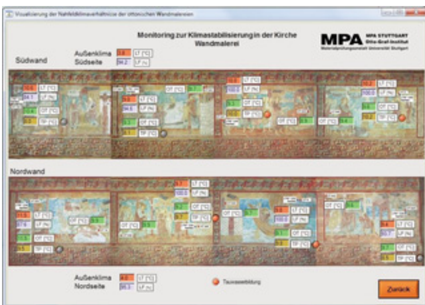
16 Monitoring zur Klimastabilisierung in der Kirche: Die einzelnen Fühler in den Bildszenen zeigen die jeweiligen Klimawerte (Temperatur, Oberflächentemperatur, relative Feuchte und Taupunkt) an, nach denen die Steuerung von Lüftung und Temperierung erfolgt.
