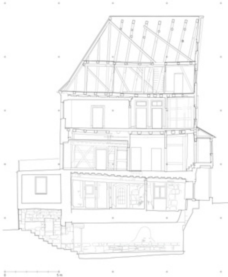
2 Längsschnitt mit Blick nach Osten: Links der Kellerabgang, über dem Erdgeschoss die Bretterbalkendecke von 1370, im ersten Obergeschoss links die 1418 eingebaute Stube mit Fachwerk von 1569, im Dach sieben schiefstehende Gespärre von 1288 und Vollwalm von 1788, rechts Ersatz des Mauerwerks durch Fachwerk von 1702.
