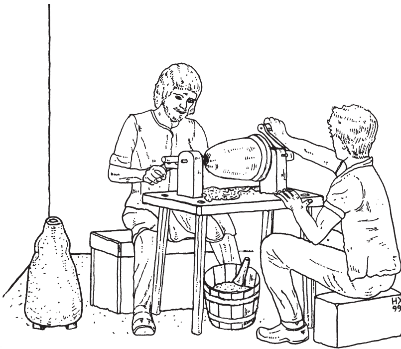
6 Herstellung einer Glockengussform an der Drehbank nach der Schedula des Theophilus Presbyter, um 1120.
