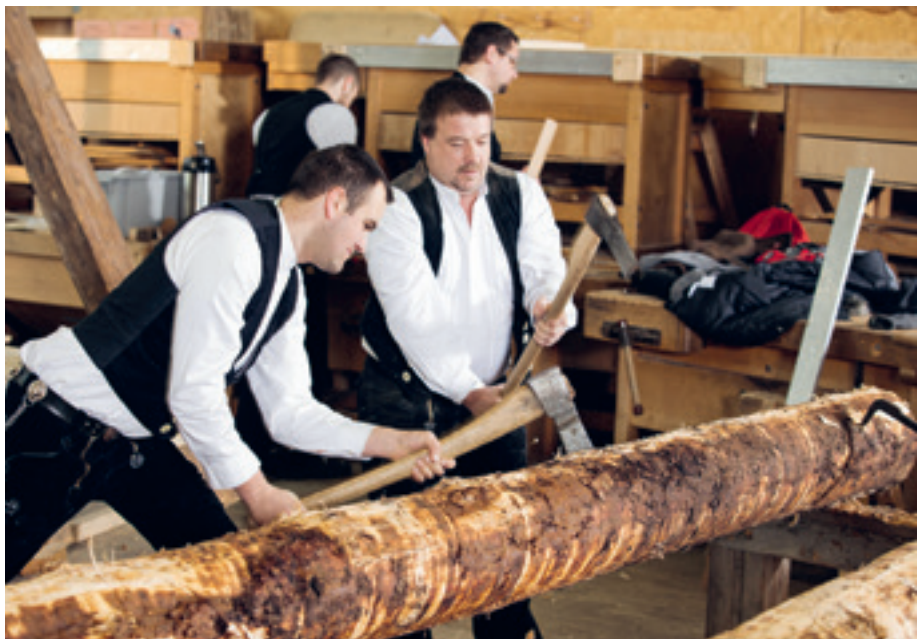
1 Im Bildungszentrum Holzbau in Biberach trainieren die Fachkräfte des Zimmererhandwerks auch das manuelle Bearbeiten eines runden Stammes per Beil.
