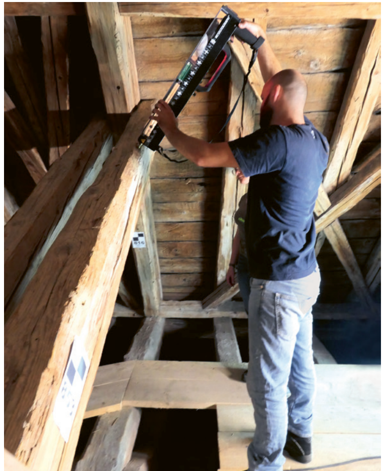
6 Bohrwiderstandsmessung an einer Strebe im Querbund.
