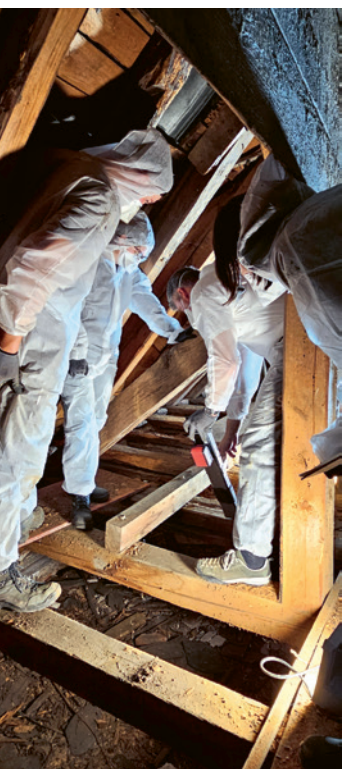
2 Teilnehmende der Summerschool bei einer Bohrwiderstandsmessung im Dachstuhl des Belvederes.
