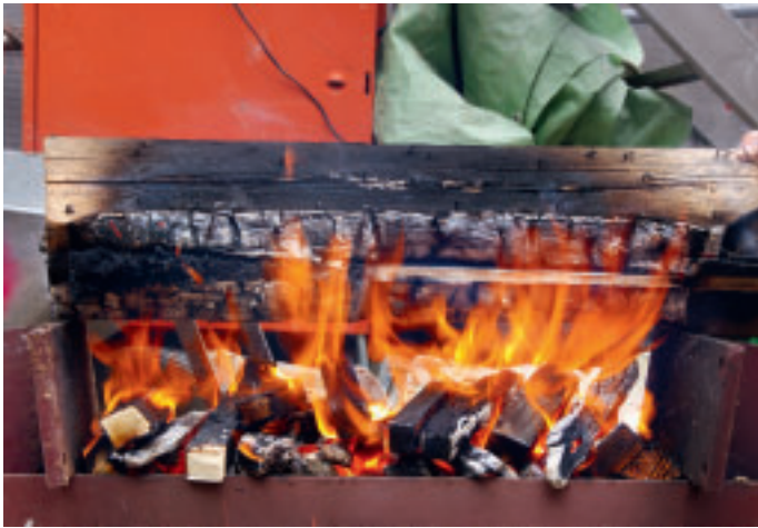
11 Prüfkörper nach 50-minütiger Beflammung von unten.
