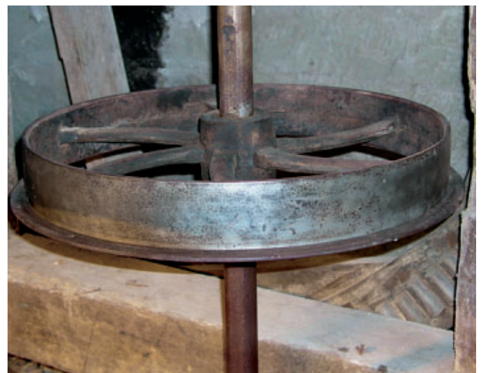
5 Ursprünglich blanke Stahloberfläche einer Transmissionsscheibe nach der Konservierung. Sie wurde im Niederdruckstrahlverfahren entrostet und mit OKS 2100 konserviert, einem Korrosionsschutzfilm auf Wachsbasis.
