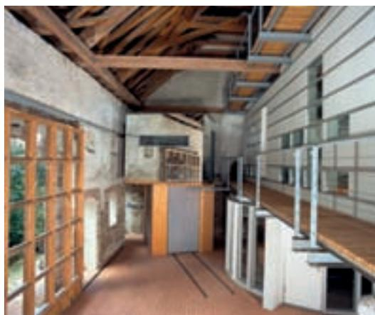
5, 6, 7 Auggen, Ellengurt. Beim Ausbau der Scheune zur Werkstatt mit Wohnbereich verzichtete der Bauherr auf zusätzliche Öffnungen in den Bruchsteinwänden und auf Dachaufbauten. Der Wohnbereich wird über das Lichtband auf der rückwärtigen Dachfläche belichtet (5), die Werkstatt über das neue Scheunentor (6). Der Innenausbau erfolgte nach dem Prinzip „Haus im Haus“ (7).
