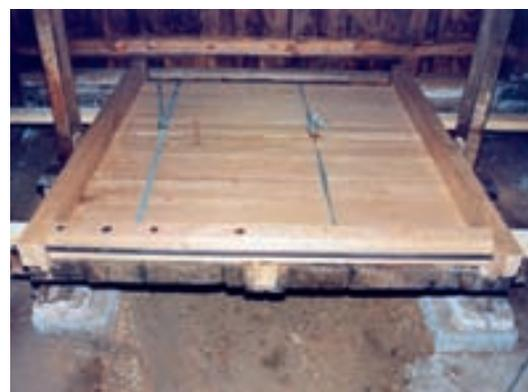
Die anderen Ausbesserungen und Ergänzungen an den Metallteilen, am Pressbett, die Aufkantung des Presskastens, die Roste, das Podest mit Nut- und Federbrettern, der Höhenausgleich und die Anpassung der vorhandenen Treppe schienen für Schlosser und Zimmerer lösbar. Die Hoffnung auf den Wiedergewinn einer funktionstüchtigen Presse wuchs!
