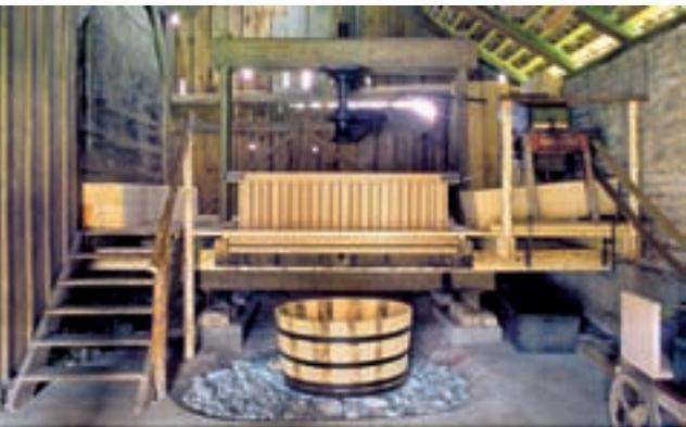
verteilen. Der letzte, aber auch spannendste Schritt war die Überprüfung auf Dichtigkeit der Presse. Das Pressbett wurde mit Wasser ausgespült, undichte Stellen mit Holzasche und Sägemehl zugeschwemmt. Schon nach ein paar Minuten war die Presse dicht und der ausführende Zimmermann konnte nun wieder ruhig schlafen.
