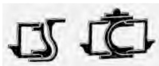
4 Julius Hoch: Aufwendige, kombinierte Walzstahlprofile, nach Vorbild traditioneller Holzfensterprofile geformt.
