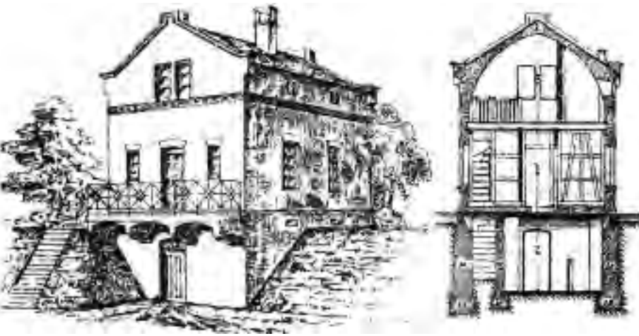
1 Bahnwärterhaus in Betonbauweise.
