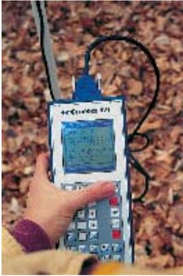
6 Mittels GPS werden die sichtbaren Reste des Limes im Gelände vermessen.
