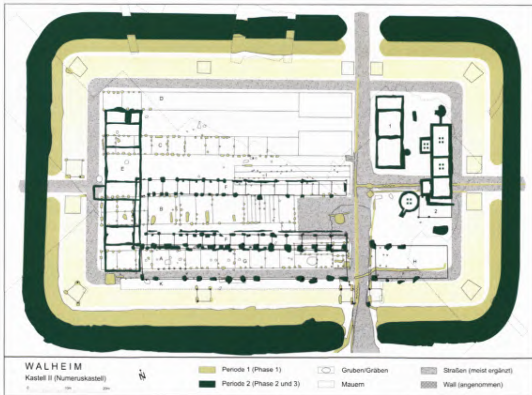
3 Überblick über die Bau- befunde des Kastells II mit den die ursprünglichen Innenbebauung über- lagernden Großbauten E, F, G und H.
