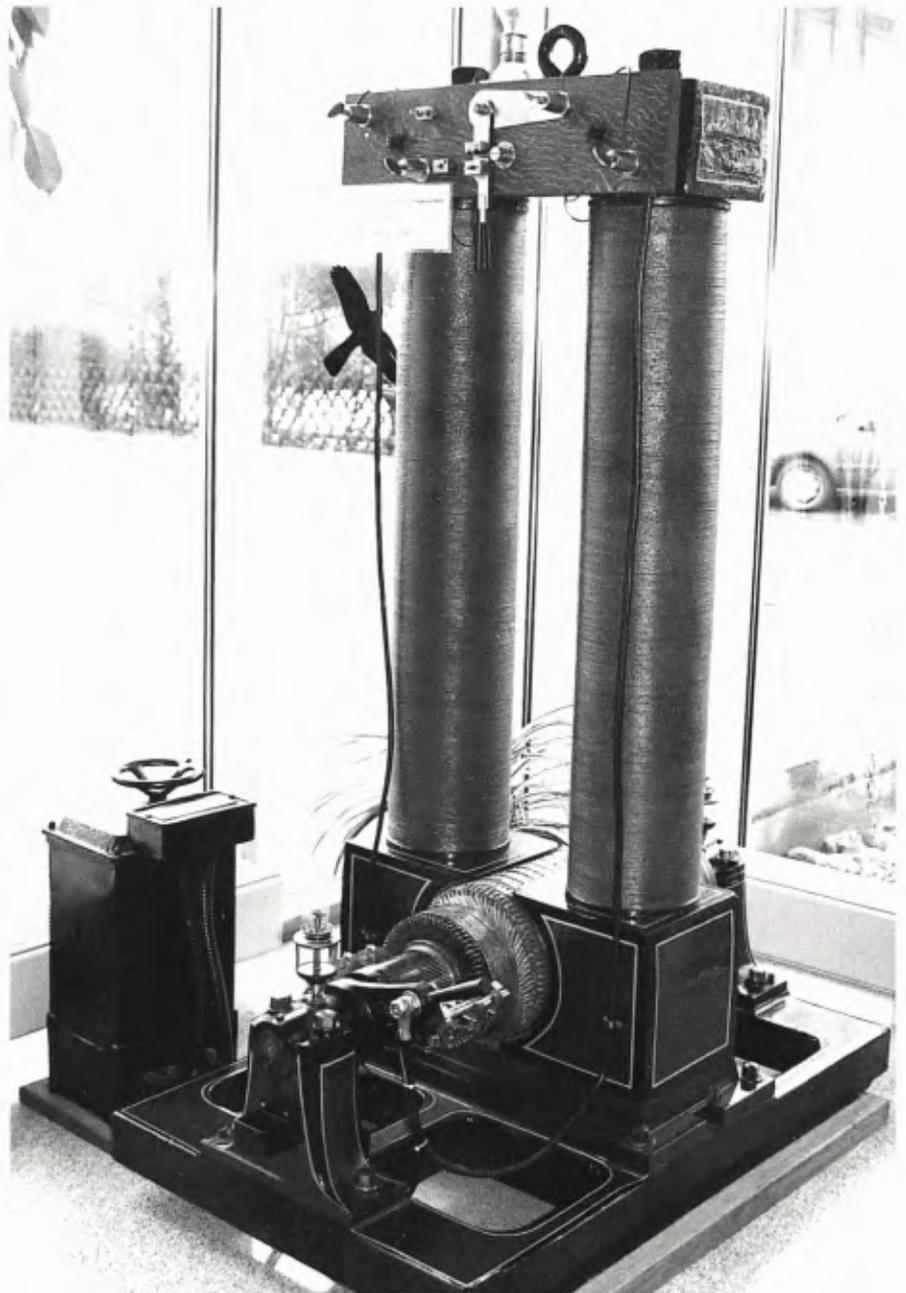
■ 1 Aus der Anfangszeit des elektrischen Glühlichts: ein Gleichstromgenerator der Edison Electric Light, Foreign N<sup>o</sup> 92, wie ihn sein Typenschild ausweist. Baujahr höchstwahrscheinlich 1881. Foto: LDA Tübingen.
