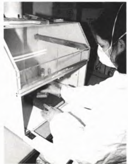
■ 2 u. 3 Reinigen und Desinfizieren eines Bucheinbandes. Foto: Badische Landesbibliothek Karlsruhe, K. Stürmlinger.
