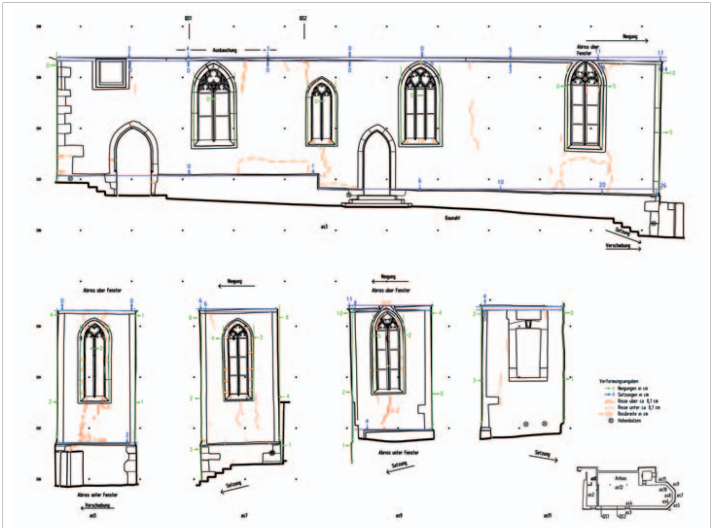
16 Südfassade und Abwicklung Chorfassaden, M. ca. 1:150; photogrammetrische Auswertung mit Rissen und Kennzeichnung der Verformungen wie Neigungen, Setzungen und Verschiebungen.
