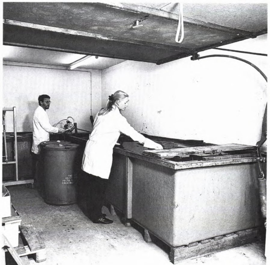
■ 2 Holzkonservierung in der Garage des LDA in Karlsruhe; rechts großes Becken, im Hintergrund kleines Becken.
