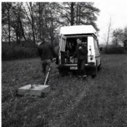
■ 3 Bodenradar. Meßfahrzeug mit der Sende- und Empfängerantenne. Die Meßdaten werden durch einen Computer im Fahrzeug gespeichert.
