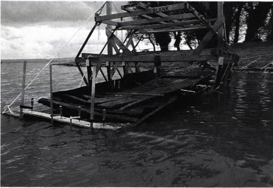
■ 2 Hebung des Heckteils mit Gurtrien und Balkenkonstruktion.
