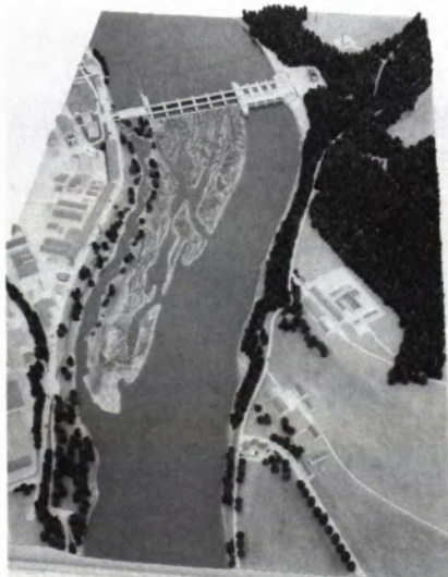
■ 14 Die Neuplanung Kraftwerk Rheinfelden sieht ein quer über den Fluß gespanntes, sogenanntes Deckelkraftwerk mit Zentrale am Schweizer Ufer vor.
