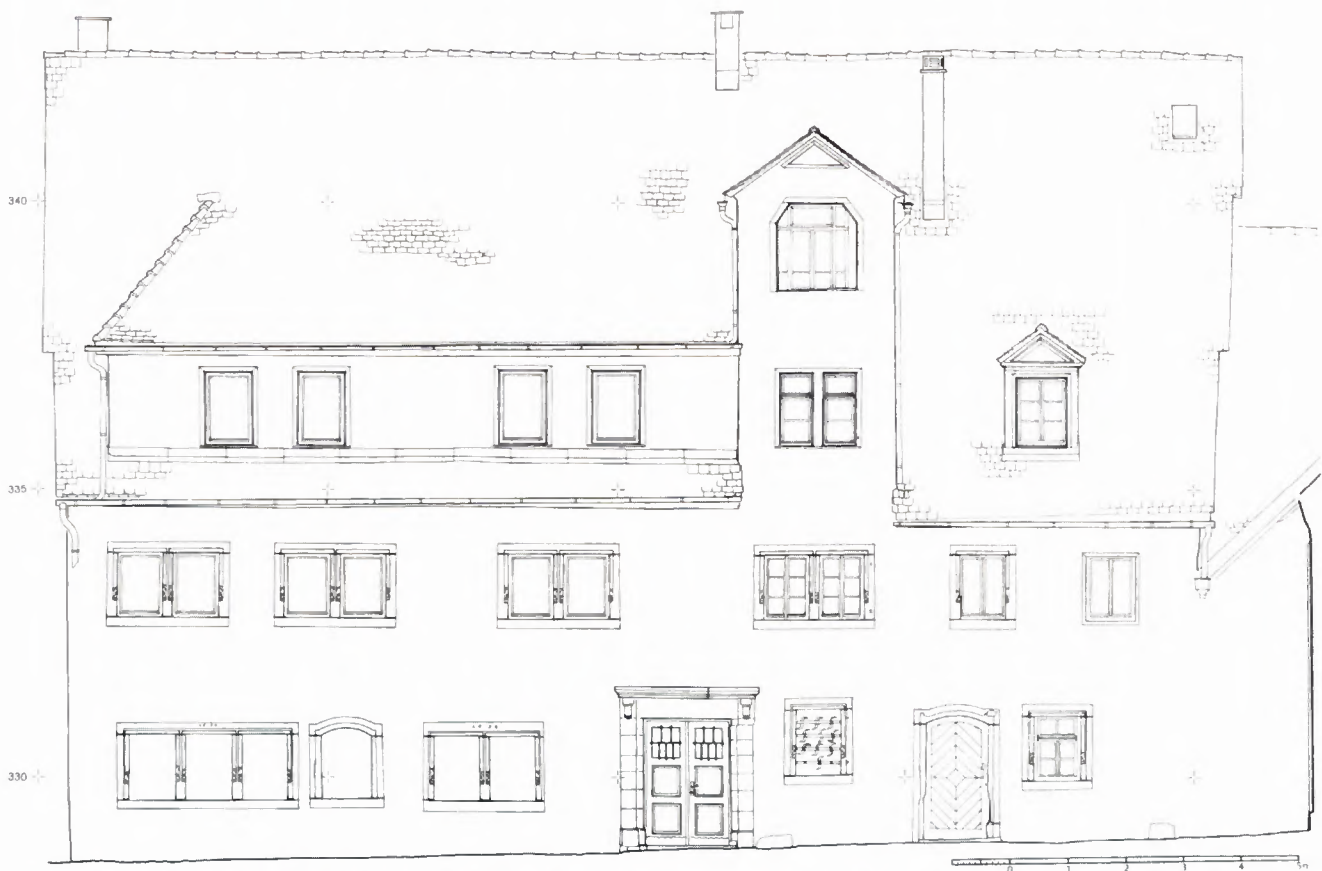
2 HIRSAU, Calwer Str. 6, photogrammetrisches Aufmaß (Juni 1985) des Baus zu Beginn der Untersuchungen mit dem damaligen Fensterbestand (urspr. M. 1 : 50).
