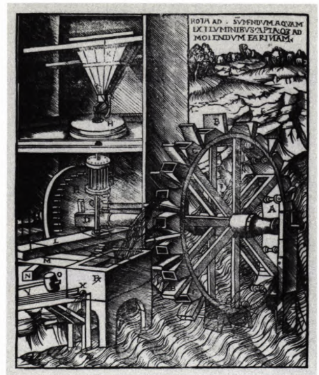
11 MAHLMÜHLE um 1521. A=unterschlächtiges Wasserrad, B=Schaufeln, C=Kammern, D=Wellbaum, E=Kammrad, G=Spindelrad, H=Mühlstein, K=Kornbehälter. Das mit den Kammern C geschöpfte Wasser trieb eine Walke an.
