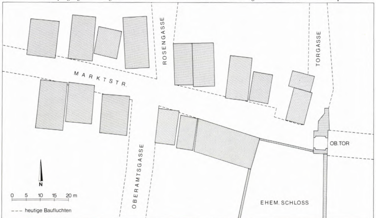
13 MARBACHER KELLERKATASTER. Ausschnitt mit dem Bereich der oberen Marktstraße und des Schlosses. 14 REKONSTRUKTIONSVERSUCH der Bebauungsstruktur vor 1693 im Bereich der oberen Marktstraße. Während die Häuser vor der Brandzerstörung gruppenweise angeordnet waren und keine einheitliche Fluchtung besaßen, wurde beim Wiederaufbau nach 1693 eine einheitliche Baulinie festgelegt. Im heutigen Hausbestand ist diese städtebauliche Entwicklung nur noch an der Wendelinskapelle ablesbar.
