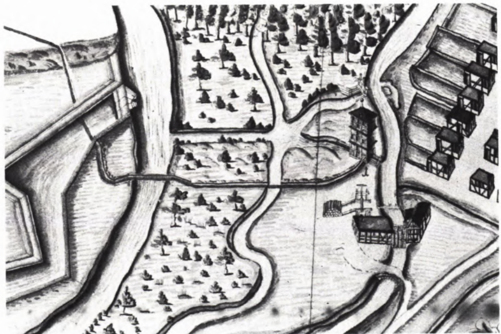
1 AUSSCHNITT AUS DEM WASSERLEITUNGSPLAN zu Beginn des 18. Jahrhunderts. Ganz links ein Teil der Befestigung, daneben von oben nach unten die Murg. Im rechten Bild Drittel der Fachwerkturm des ersten Brunnenhauses. Darunter ist eine Vorrichtung zum Bohren der hölzernen Deicheln erkennbar. Die Wasserleitung ist auf einem Steg über die Murg geführt. Dessen ursprüngliche Bezeichnung „Röhrensteg“ wurde später infolge irrtümlicher Interpretation durch den Namen „Rohrersteg“ abgelöst.
