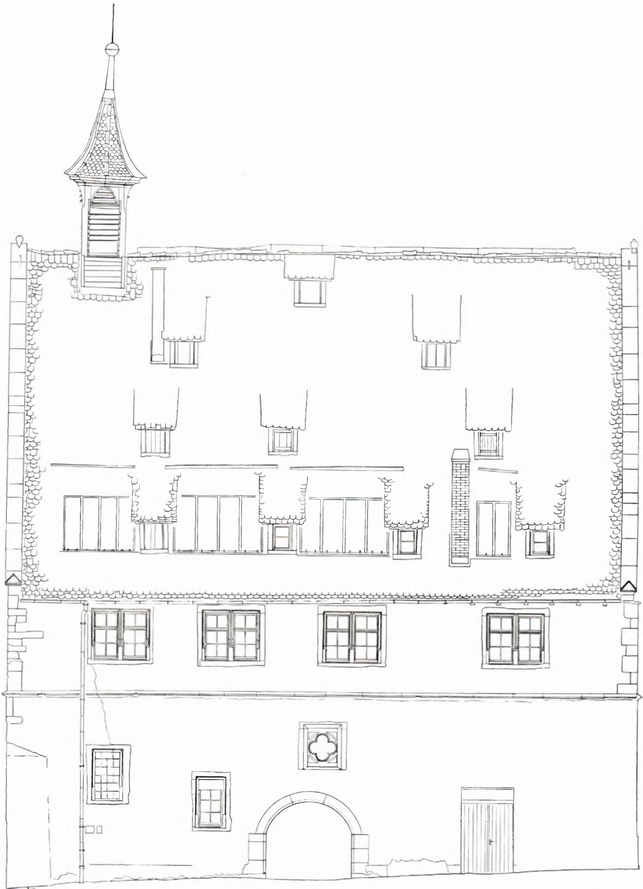
4 DIE ALTE KELTER IN MÜHLACKER mit ihren Anbauten soll als Museum ausgebaut werden und wird nach dem Konjunkturförderungsprogramm bezuschußt. Zur Vorbereitung der Baumaßnahmen wurden alle Fassaden aufgenommen und in ihrem Zustand dokumentiert.
