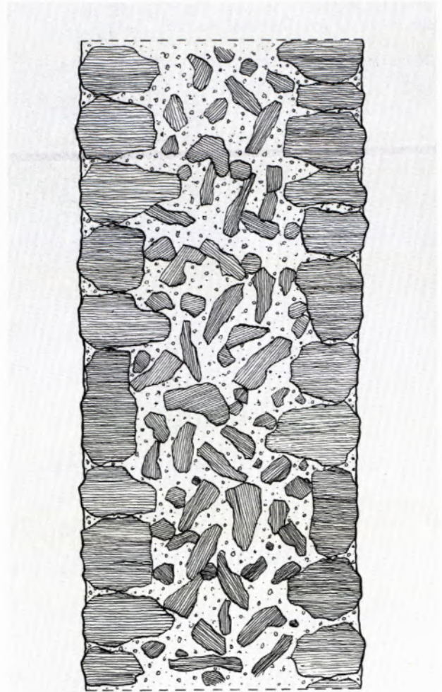
8 SKIZZE EINER MAUERAUFSICHT mit großen, unregelmäßigen Schalsteinen und vortretenden Steinen des Füllmauerwerks.
