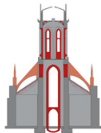
11 Schematische Darstellung der Ausbauphase im 19. Jahrhundert: Strebewerk 1856–1873 (hellrot) und Verstärkungsmaßnahmen für den Turmausbau 1882–1885 (dunkelrot).
