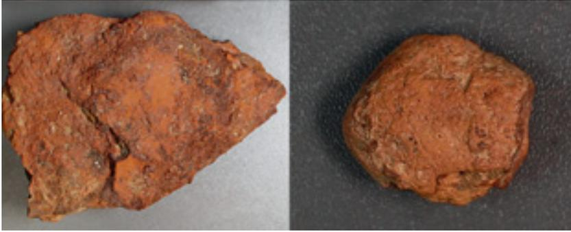
2 Beispiel unterschiedlicher Erzgruppen, die während des Mittelalters im nördlichen Albvorland intensiv abgebaut und weiterverarbeitet wurden. Links: Stufferz, Länge des Objekts 10 cm; rechts Tonerz, Durchmesser ca. 2 cm.
